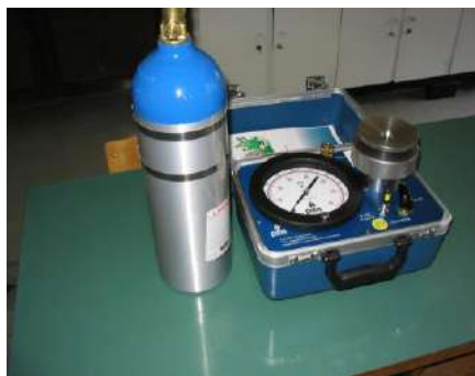
Слика 7. Комора под притисок “pressure chamber” (извор Чукалиев и Танасковиќ, 2006)
